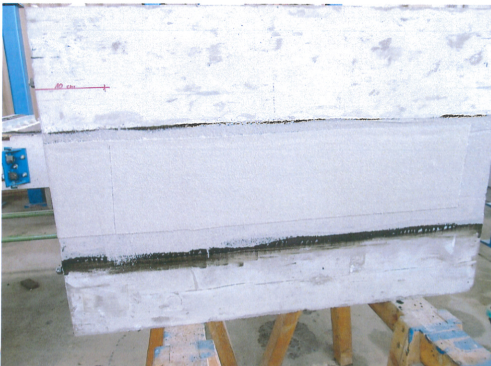
Bild 6 Applikation des Polyestergerstellervlieses mittig über die Fuge
